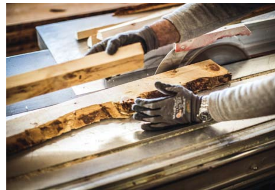
An der Kreissäge ist der Tischler oft zu finden, hier längt er die Bretter und Pfosten für ein Bett aus Zirbenholz ab.
